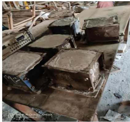
FIG: 5.3. Cube Casting
